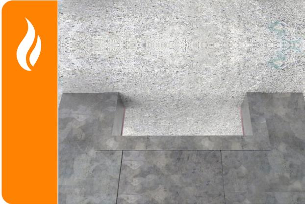
安裝C形管道的SpeedPanel，以包圍整個FyreBOX™。確保FyreBOX™與外牆開口的環狀間距於5mm至20mm之間。
