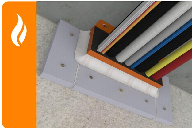
在FyreBOX™的一側，使用厚30mm及闊100mm大小的FyreBOARD Maxilite套管條固定，包圍FyreBOX™的三段外露面，以構造FyreBOARD Maxilite外牆套管。於距離中心150mm的位置，用每個重10g長60mm的螺絲釘上石膏板，將FyreBOARD Maxilite鎖緊。須要確保FyreBOARD Maxilite與外牆開口固定嵌上於同一水平（Trafalgar強烈建議由已獲審批的FyreBOX™認證夥伴來完成此項工序）。
